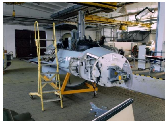
图表 31: AN-APG-68 火控雷达
