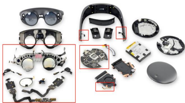
图56: AR/VR 使用大量软硬板
