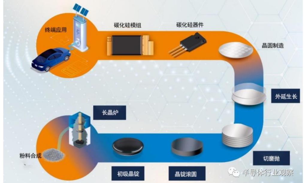
图表44: SiC 产业链较长，每个环节对技术和资本的投入要求都较高
