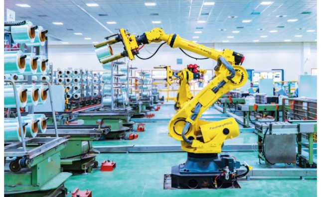
图30：中国巨石智能玻纤工厂机械手
