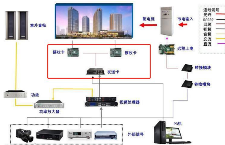
图 11：led 显示控制系统包括接收发送、视频处理、外部信号等环节
