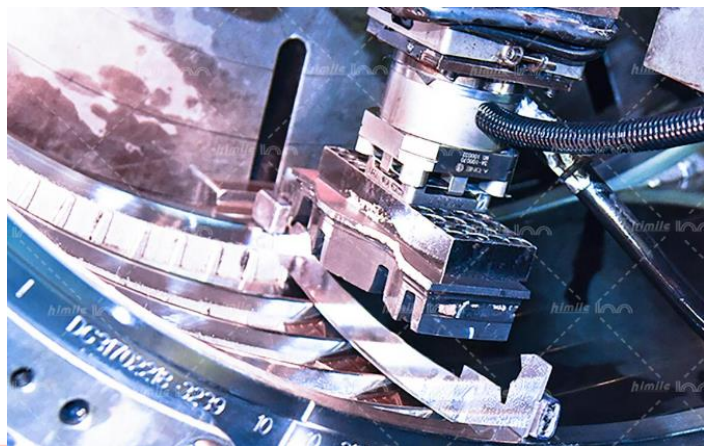
图：豪迈科技电火花加工现场图
