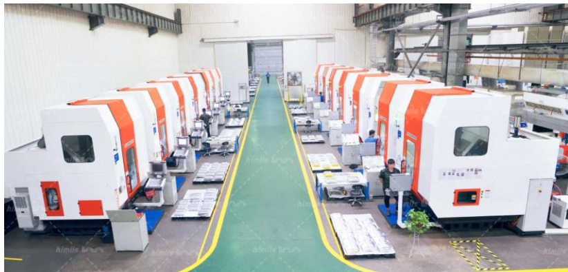
图：豪迈科技自主研发的五轴打孔机群
