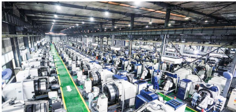
图：豪迈科技自主研发的五轴打孔机群
