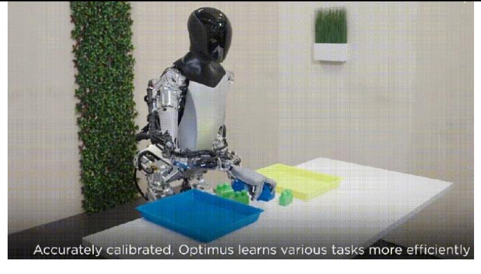
图 20: Optimus 完全自主按颜色对色块进行排序
