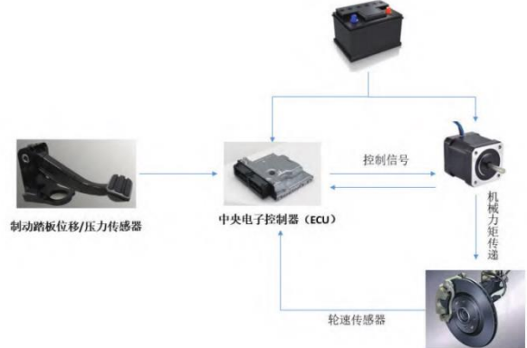
图 26: EMB 系统工作原理
