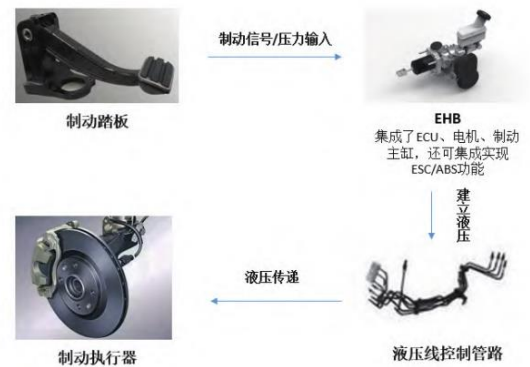
图 22: EHB 系统工作原理
