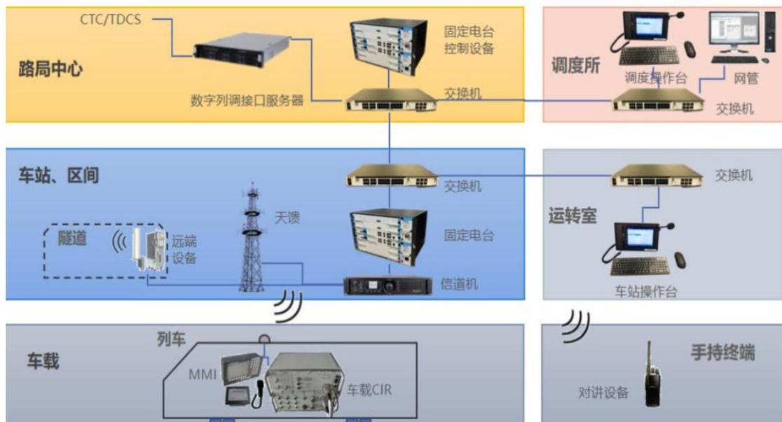
图表23 400MHz数字无线列调系统架构图
