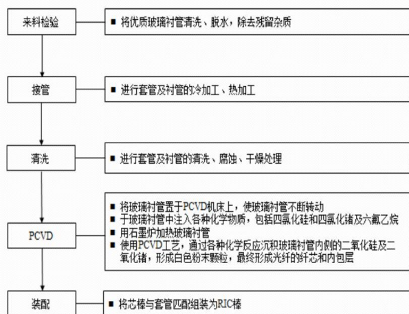
图 16: PCVD+RIC 光纤预制棒制造工艺流程示意图
