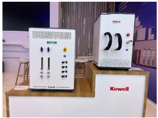
图 11：Kewell 电解槽单池测试系统
