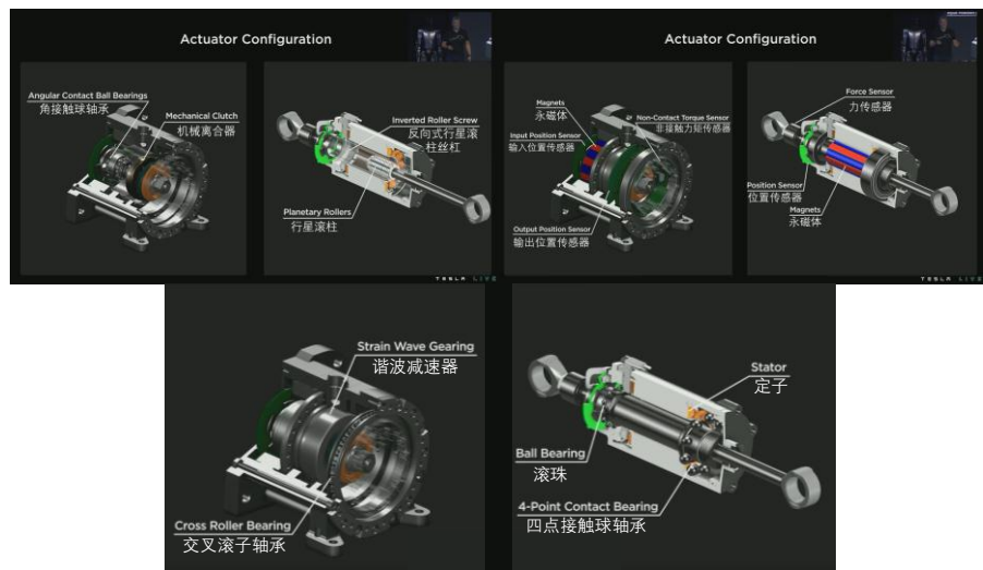
图 3：特斯拉人形机器人不同执行器零部件构成情况
