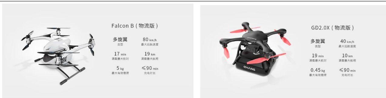
图 4：亿航智能自动驾驶飞行器 Falcon B(物流版) 图 5：亿航智能自动驾驶飞行器 GD2.0X (物流版)
