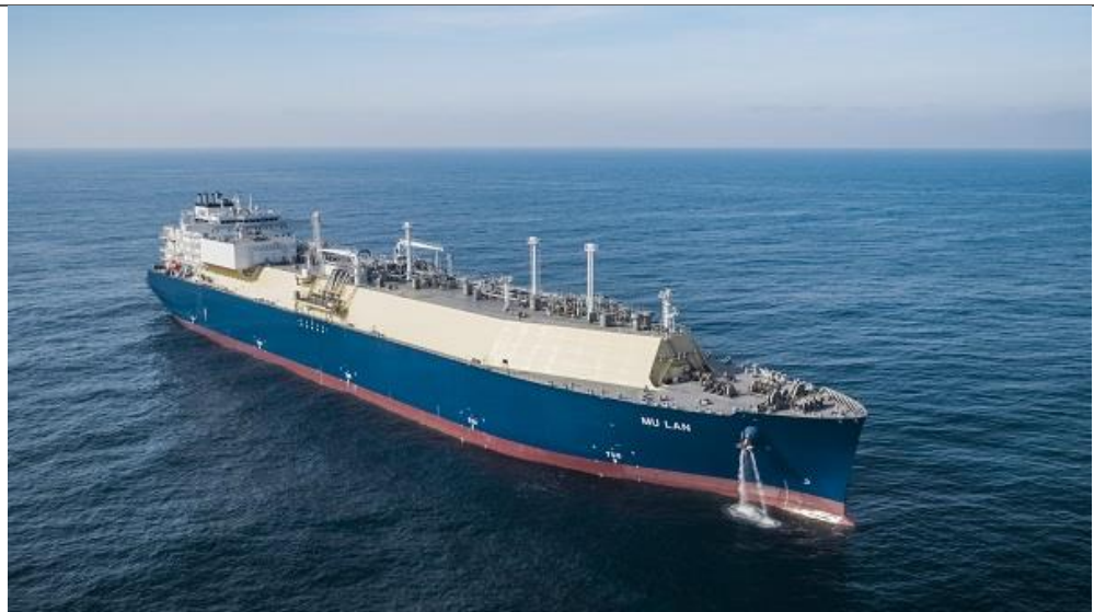
图38. 沪东中华 17.4 万立方米 LNG 船“木兰”号
