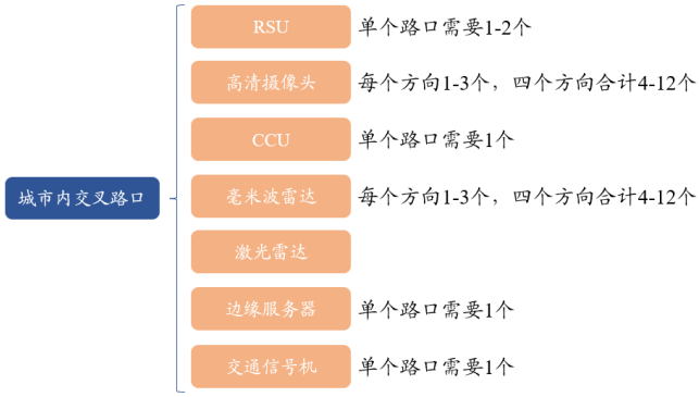
图17: 城市交叉路口 C-V2X 改造涉及的设备
