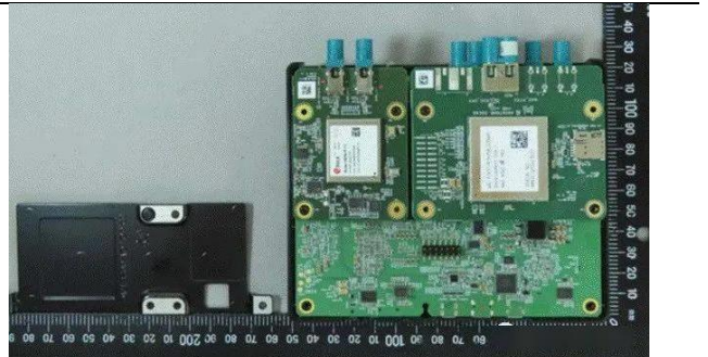
图20: OBU 内部主要为 PCB，包括 DSRC 和 4G 收发板
