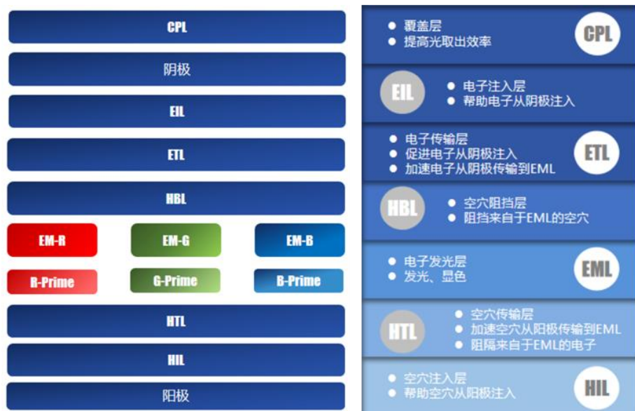
图 44: OLED 器件材料结构和作用
