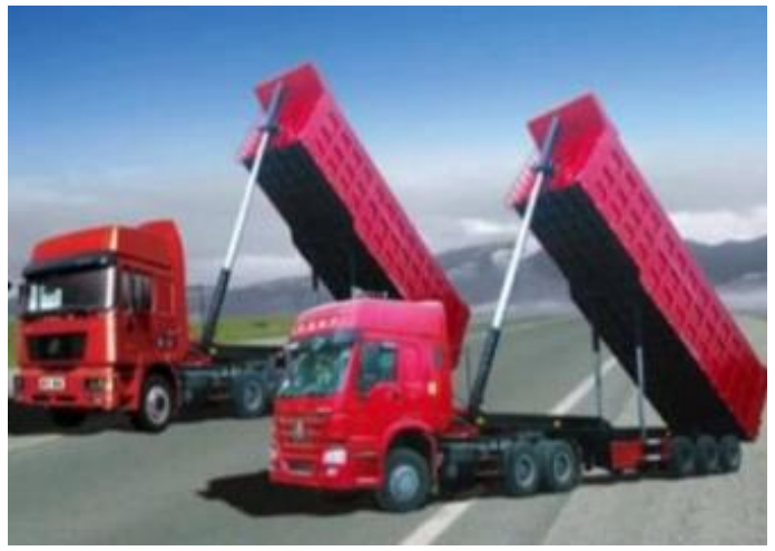
图30：自卸车专用油缸终端应用场景
