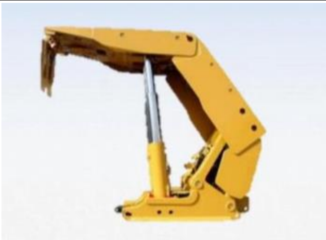
图31：矿用液压支架图示
