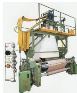
图10：机械式提花机：单动式上开口提花机
