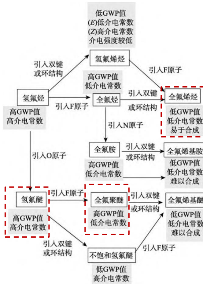
图表38：现有浸没式冷却液的物化性质的比较
