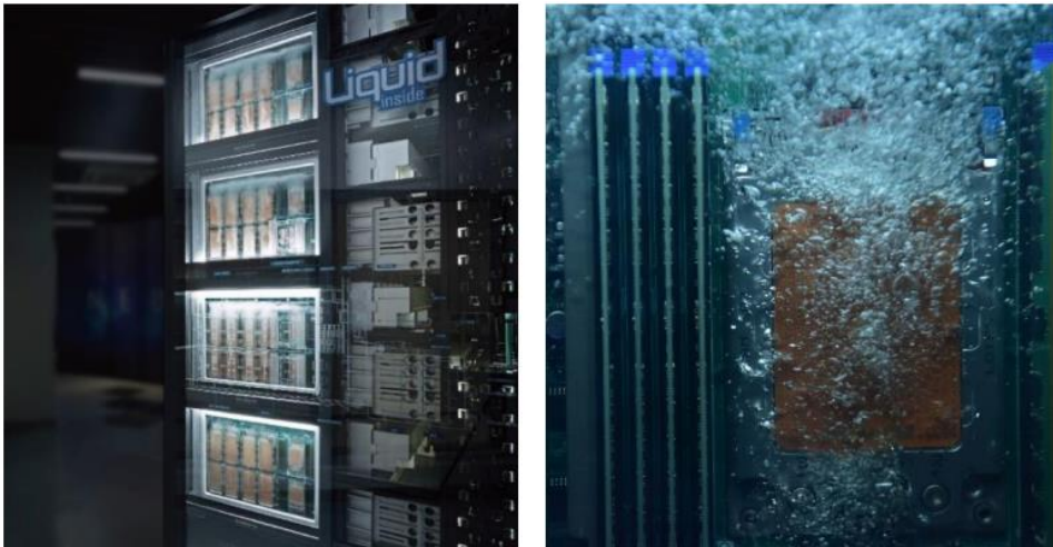
图32: 曙光数创浸没液冷服务器工作过程图
