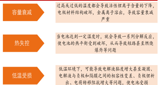
图 44：锂电池偏离工作温度区间可能产生的问题
