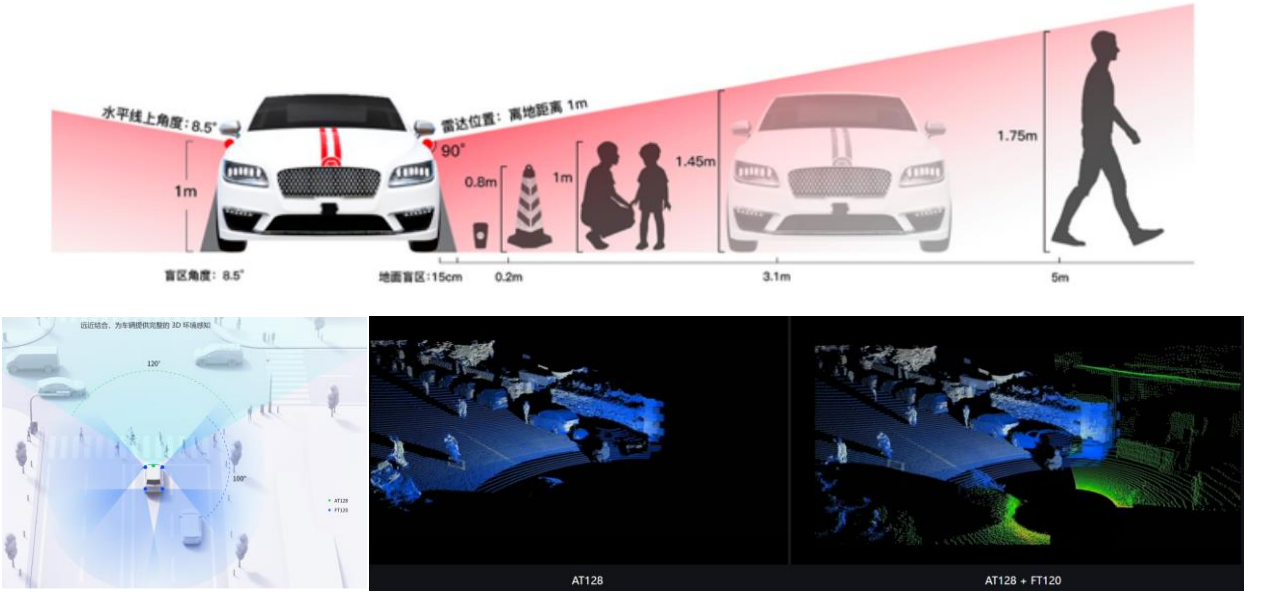
图 补盲激光雷达部署及禾赛科技AT+FT组合方案示意图
