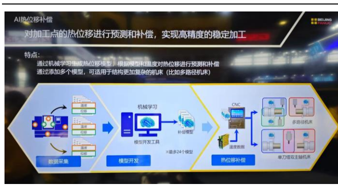
图8：AI 热位移补偿实现高精度稳定加工
