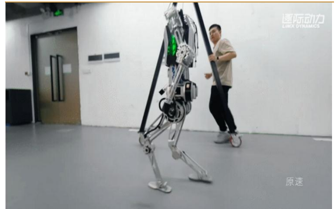
图 3: 基于全身运动控制, CL-1 完成整套跑步动作
