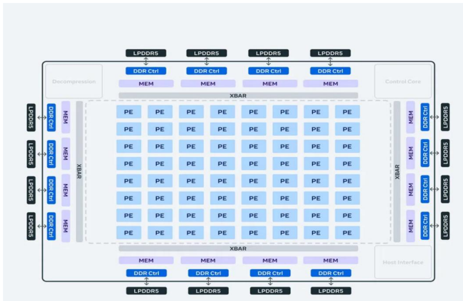
图14: 该加速器由 8x8 处理元件 (PE: processing elements) 网格组成
