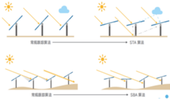
图表34: STA 算法与 SBA 算法示意图
