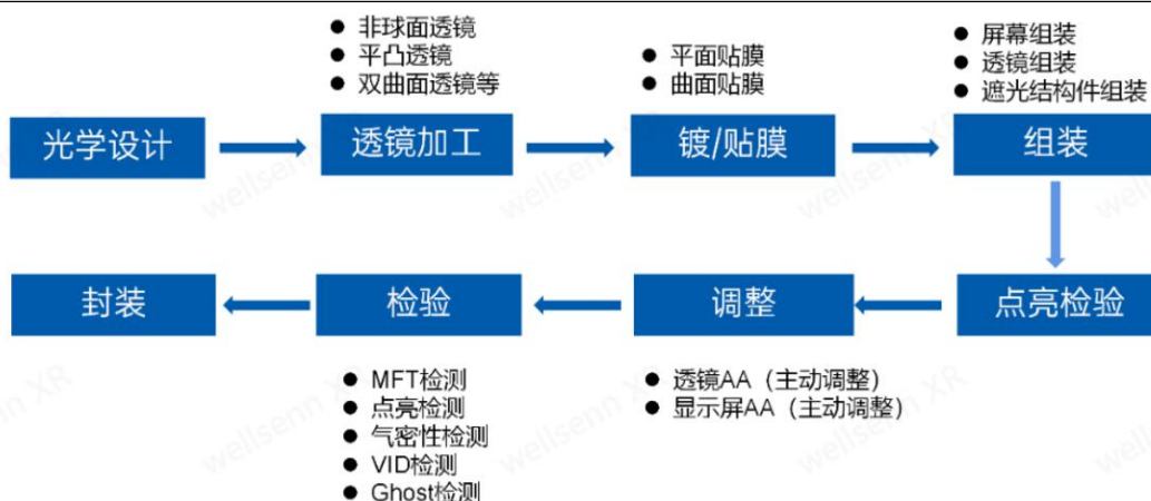
图 15：Pancake 模组生产加工流程
