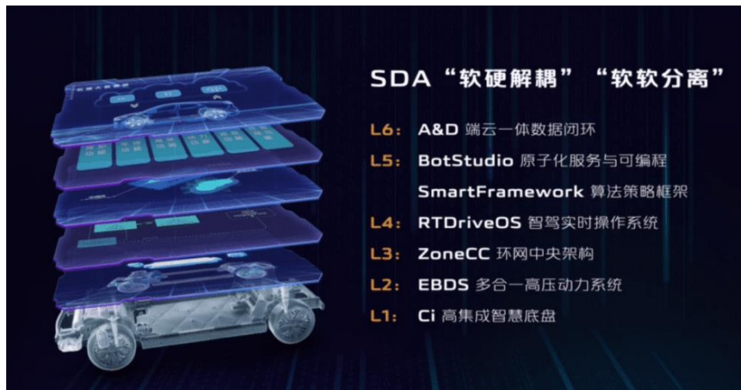
图8：长安汽车新一代SDA新能源汽车架构
