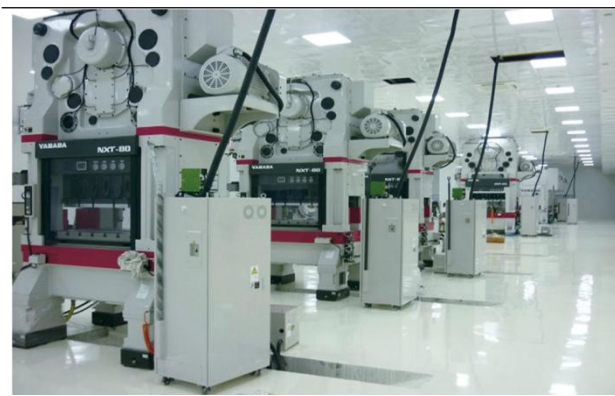
图20: 公司日本进口国内独家精密高速冲压设备
