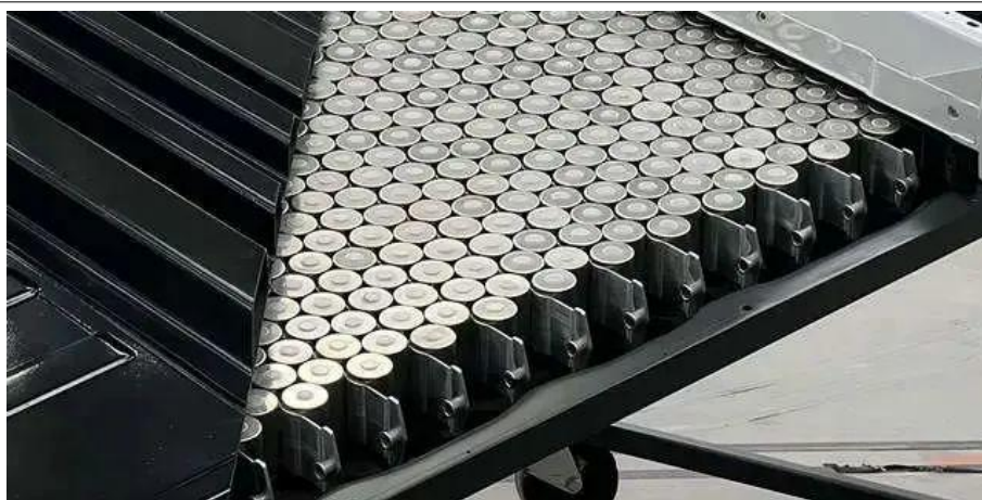
图26：特斯拉大圆柱电池 CTC 设计
