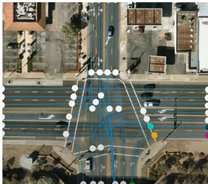
图表48：特斯拉构建了矢量地图，弥补 BEV 构建的像素级车道的不足
