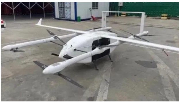
图表 3：珠海、深圳间无人机低空快递物流航路“丰舟 90 型”无人机
