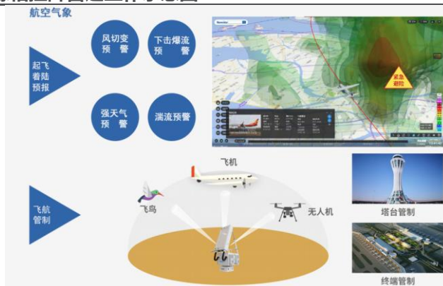
图14: 有源相控阵雷达工作示意图
