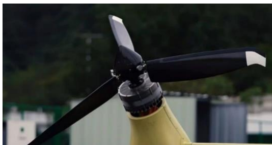
(b) 小鹏汇天公布的电动倾转旋翼机采用的自动变距螺旋桨
