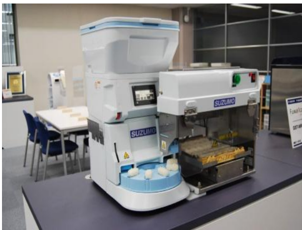
图60：日本回转寿司店的寿司机器人
