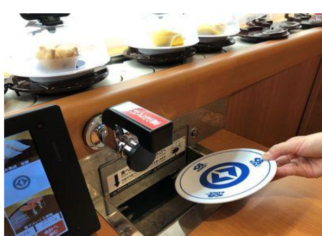
图61：日本回转寿司店的自动计数和集水系统
