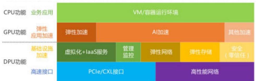
图51：通用超异构处理器（GP-HPU）实现芯片系统易于交互和拓展
