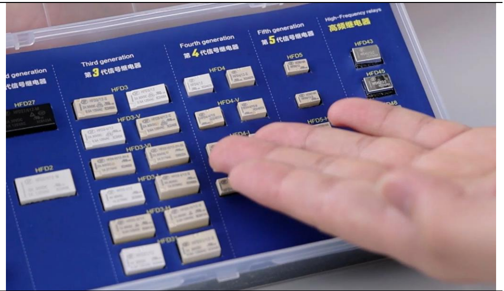
图31：公司第五代信号继电器相较于第四代产品体积降低 40%
