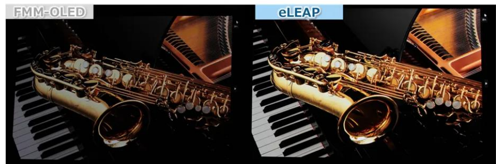
图 44: 14 英寸 eLEAP(1600nits)与传统 FMM-OLED (400nits,其他公司的产品)对比
