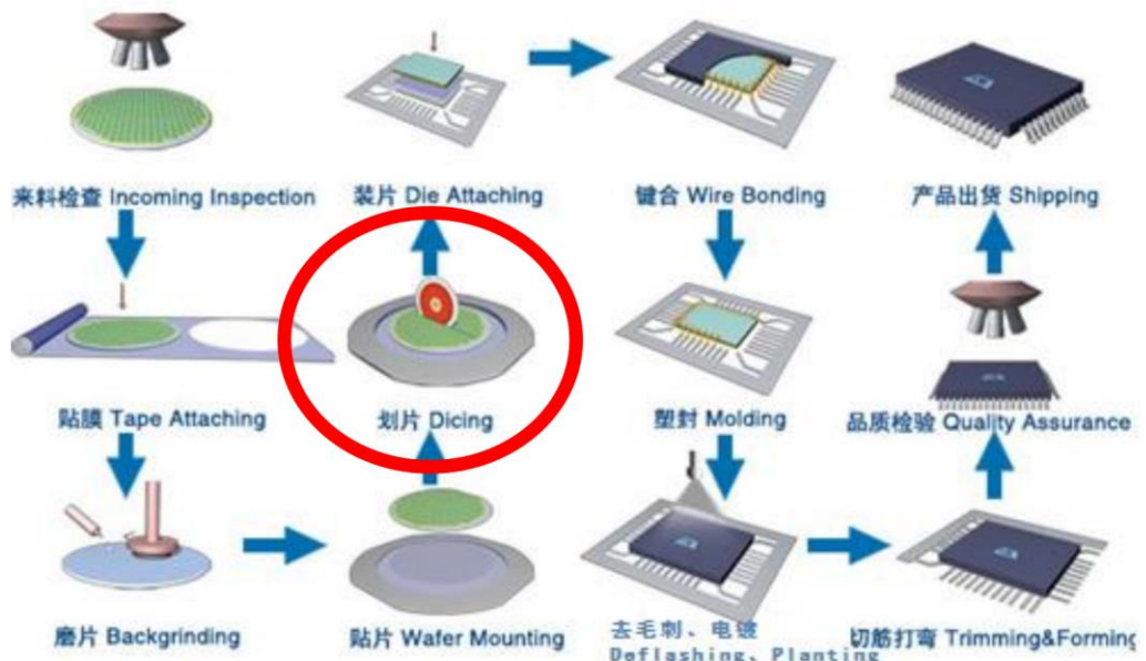
图 7：半导体封装划片刀在半导体封装工艺中的使用示意图
