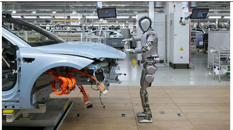
图4 优必选工业人形机器人 Walker S 在蔚来工厂进行实际操作
