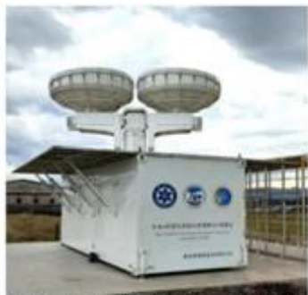
X/Ka 双波长双极化多普勒云/雨雷达
