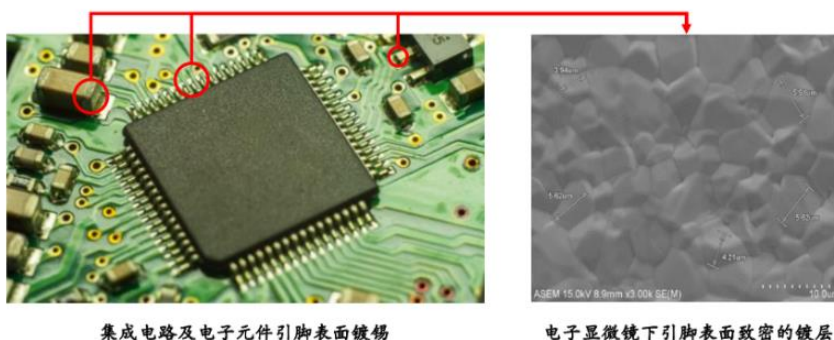
集成电路及电子元件引脚表面镀锡
