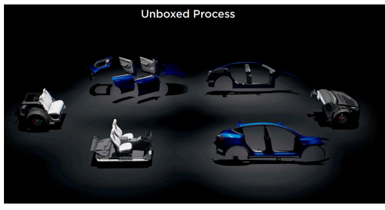
图15：Unbox将汽车解构为6个部分
