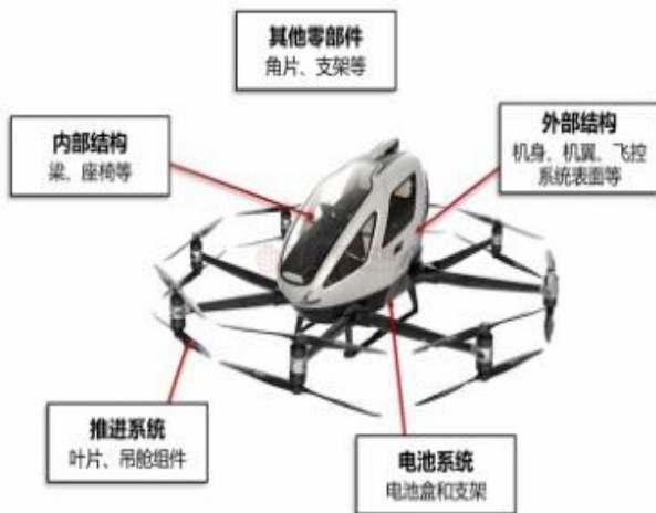
图表 48：碳纤维复合材料在机身多个部位多有应用
