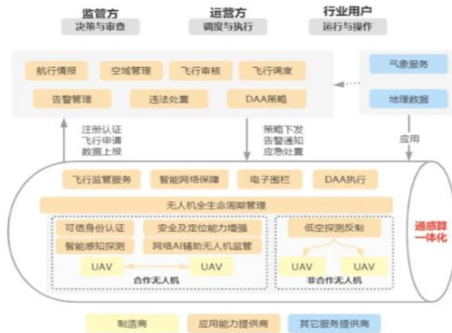
图表 31：通感算一体化的低空信息基础服务体系
