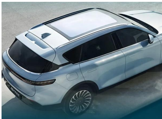
图16: 岚图 FREE PDLC 调光+镀膜隔热全景天幕
