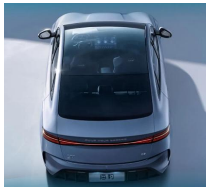
图17: 比亚迪海豹搭载 EC 调光+LOW-E 全景天幕
