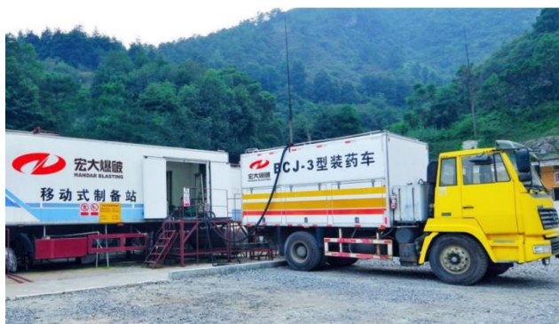
图37：广东宏大现场混装炸药地面站及混装炸药车
