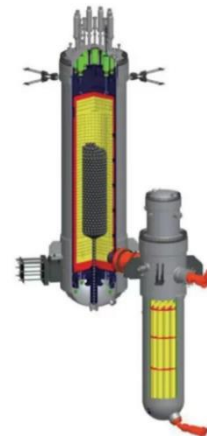
图24. 模块式高温气冷堆的一个反应堆模块
