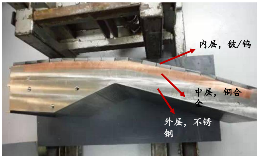
图24：ITER第一壁的三层结构
