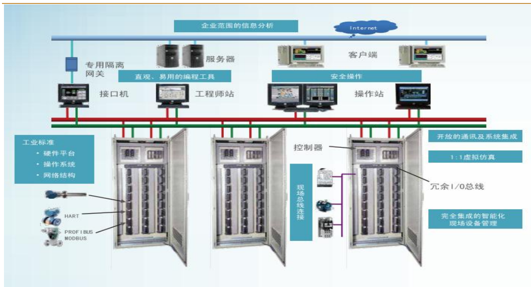
图 7：公司自主可控 NT6000 系统架构
