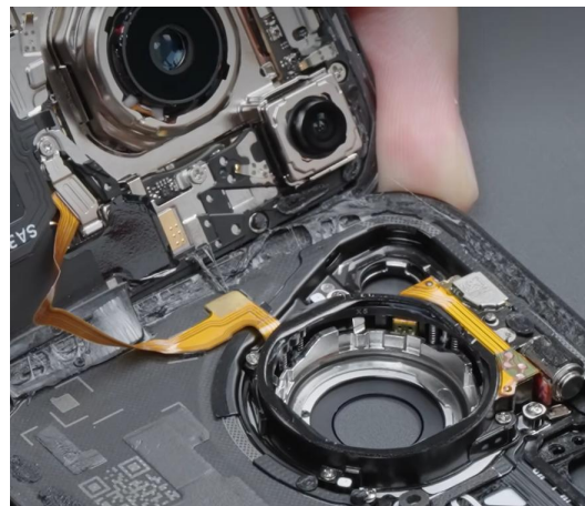
图：华为Pura 70 Ultra 旋动伸缩镜头结构
