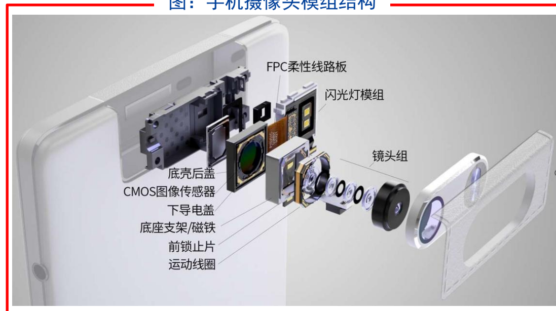
图：手机摄像头模组结构
