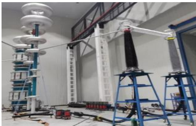
图 21：国产绝缘料 220kV 电缆型式试验现场
