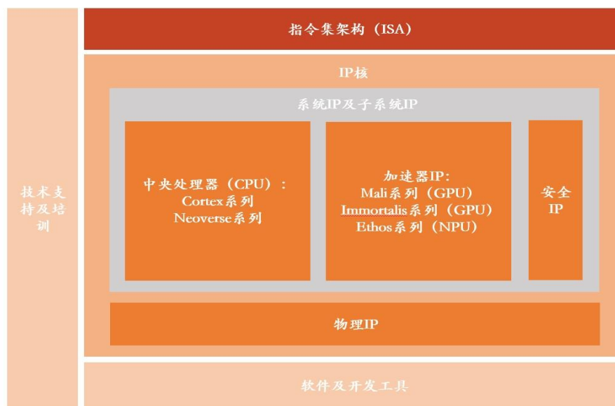
图 7: Arm 以 IP 核为核心，指令集底层架构和生态为辅
